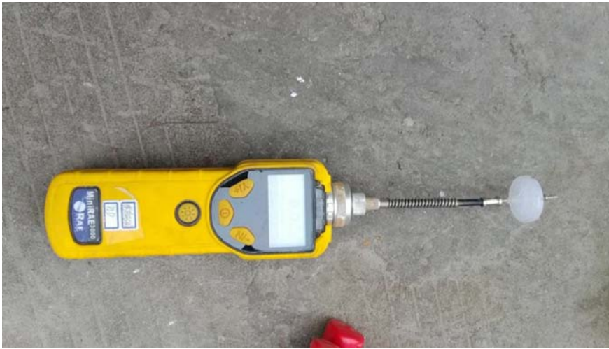
图 9.4.2-2 PID 快速检测设备
