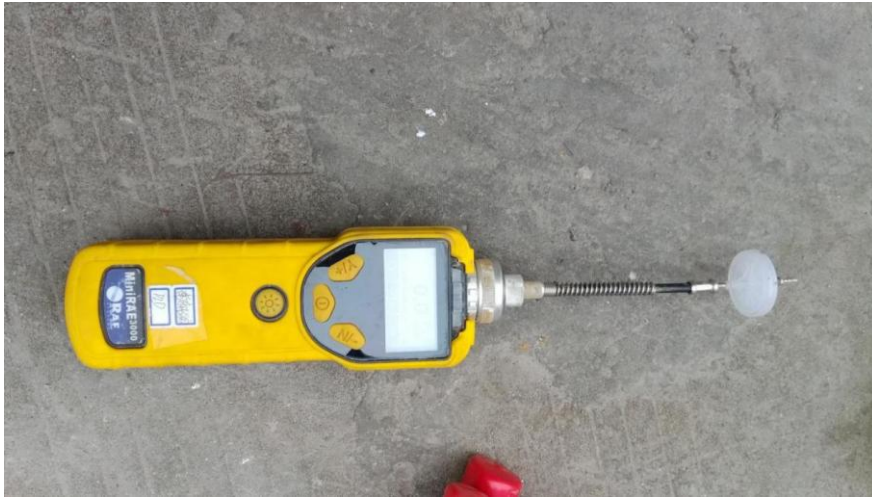
图 9.4.2-2 PID 快速检测设备
