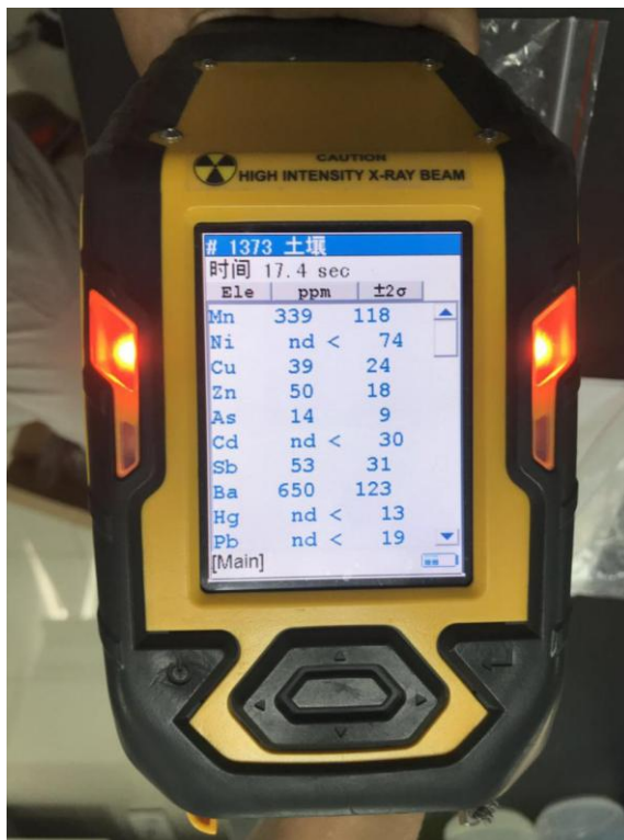
图 9.4.2-3 XRF 快速检测设备
