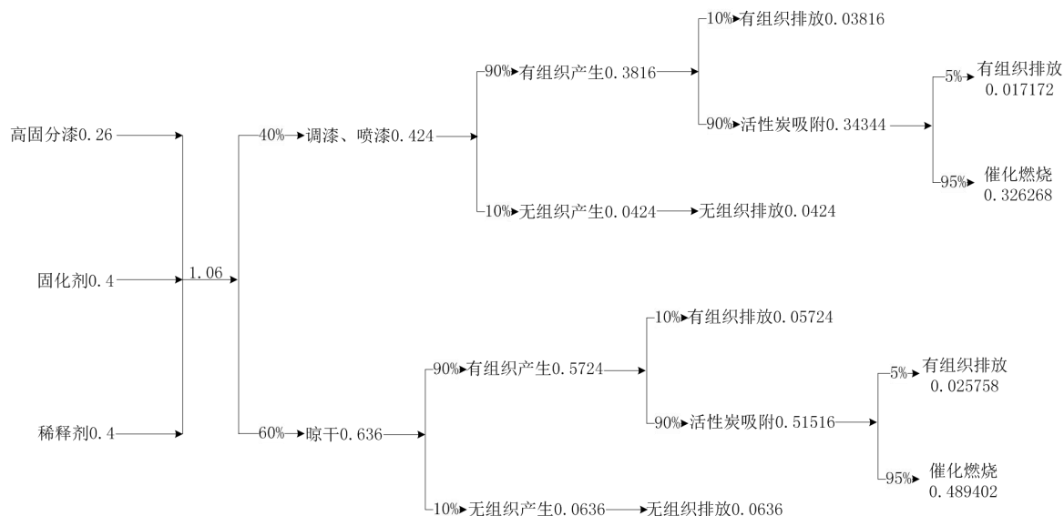
图 5-3 本项目漆料 VOC 平衡图 (t/a)
