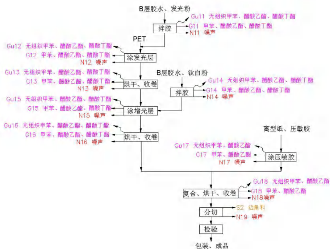
图 3.2-2 发光膜生产工艺流程及产污环节图
