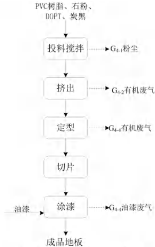
图 2-15 原项目 PVC 地板生产工艺图
