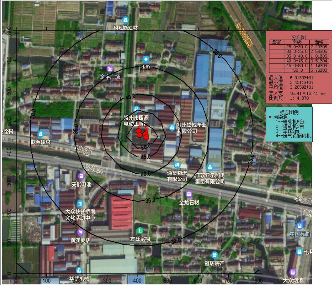
图 4-3 本项目投产后等声值线图
