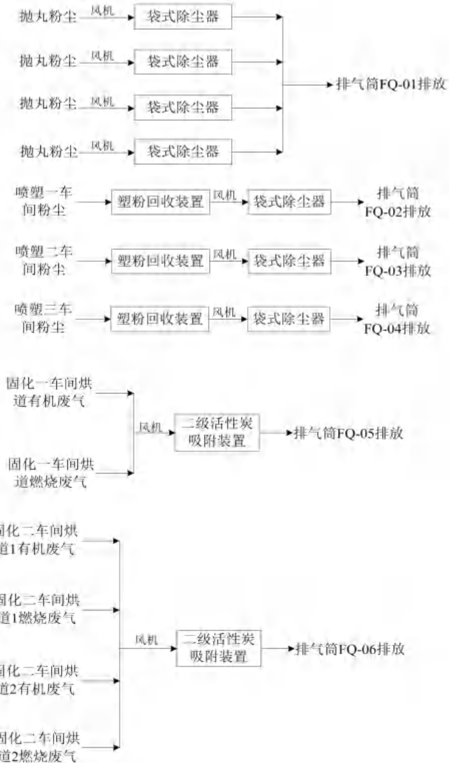
图 4-1 本项目各工段废气处理工艺图
