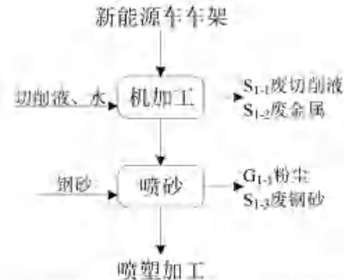
**图 2-6 本项目新能源汽车车架总体生产工艺图**
