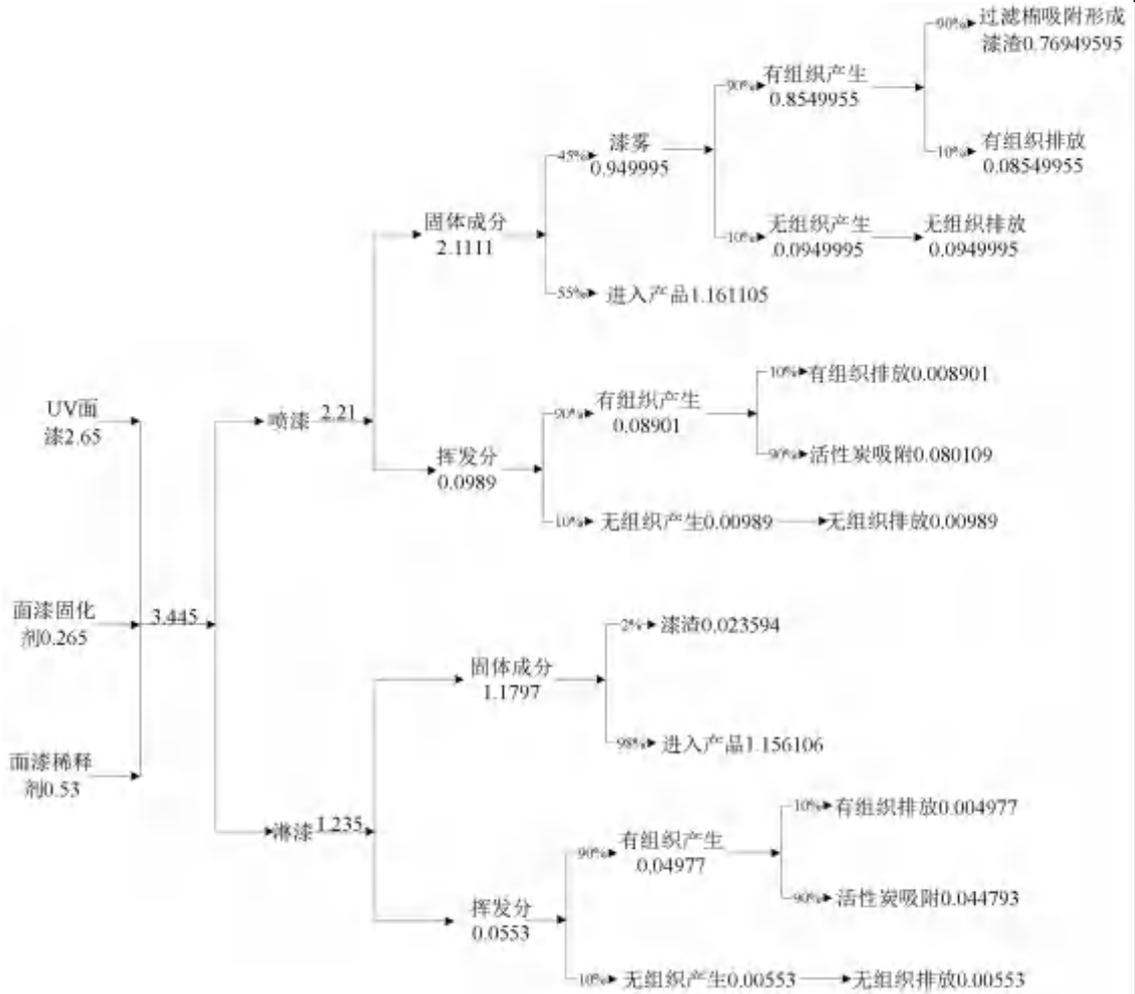
图 2-3 本项目面漆用量平衡图 (t/a)
