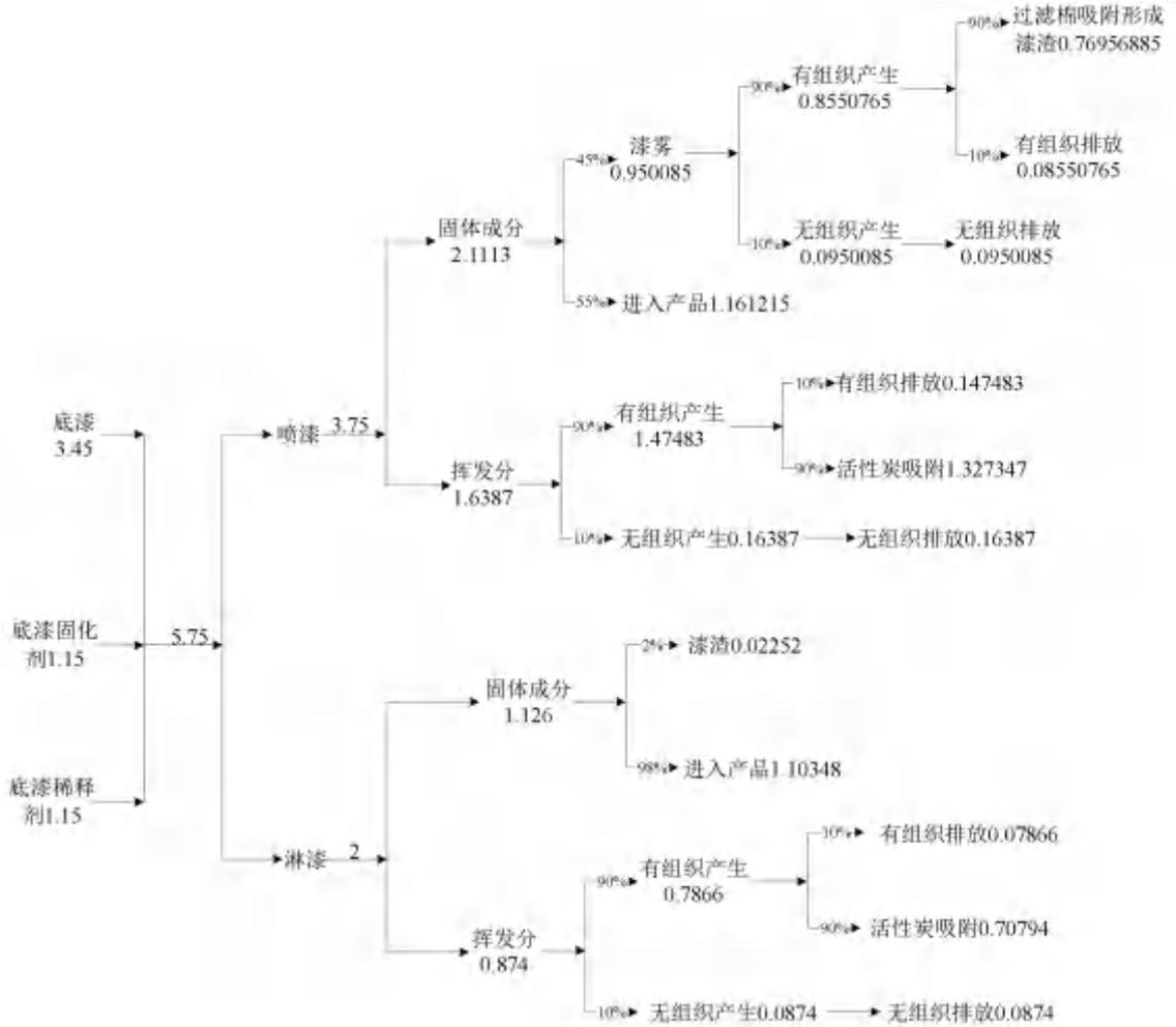
图 2-2 本项目底漆用量平衡图 (t/a)
