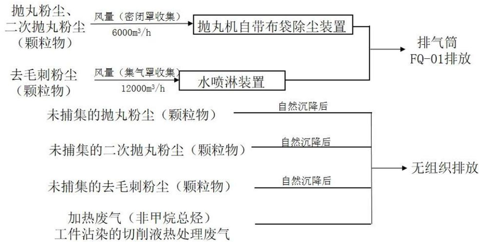
图 4-1 本项目各工段废气处理工艺图
