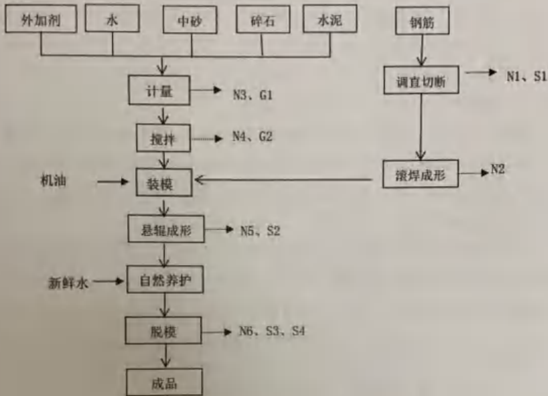
图 2-2 雨污管的生产工艺流程及产污环节图
