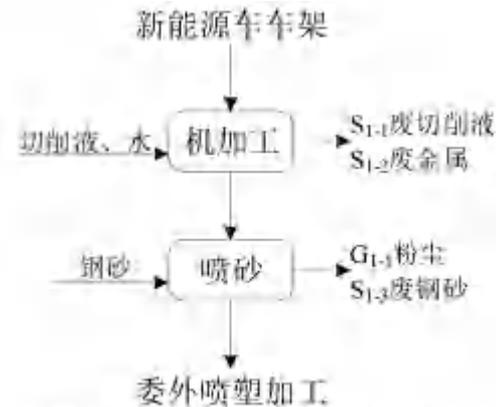
图 2-5 本项目新能源汽车半架总体生产工艺图
