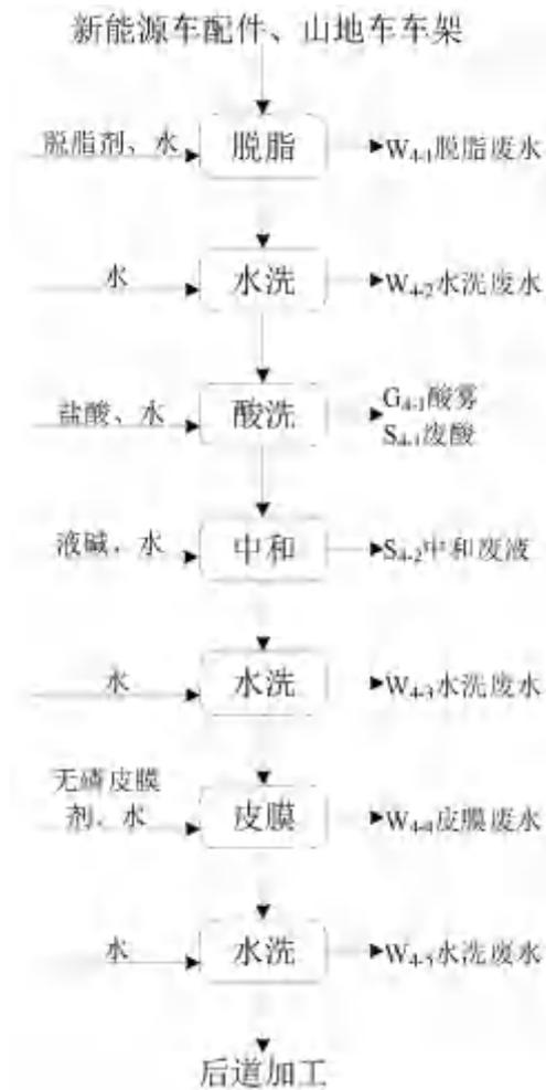
图 2-16 实际酸洗线加工工艺流程图
