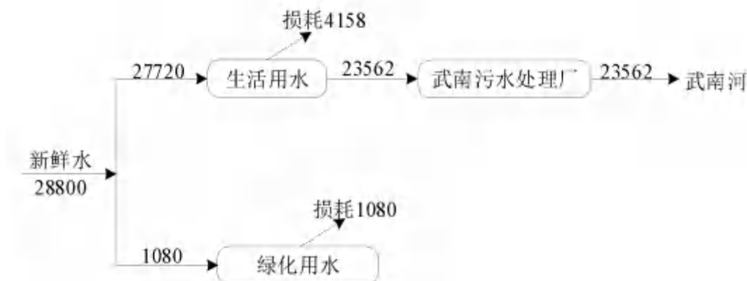
图 4-7 本项目投产后全厂水平衡图 (t/a)
