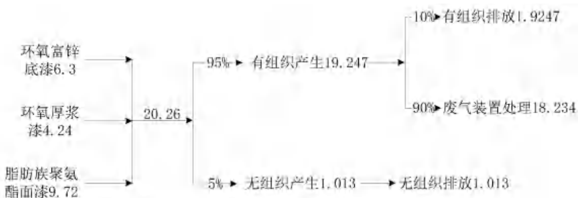
图 4-4 本项目生产过程中 VOCs 平衡图 (t/a)
