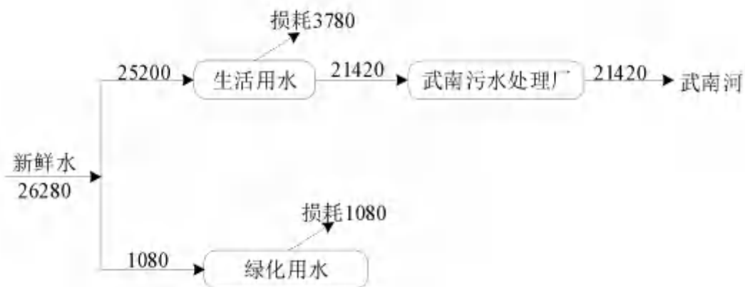
图 3-3 企业原项目水平衡图
