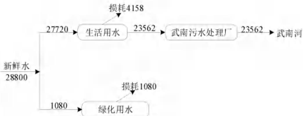
图 4-7 本项目投产后全厂水平衡图 (t/a)
