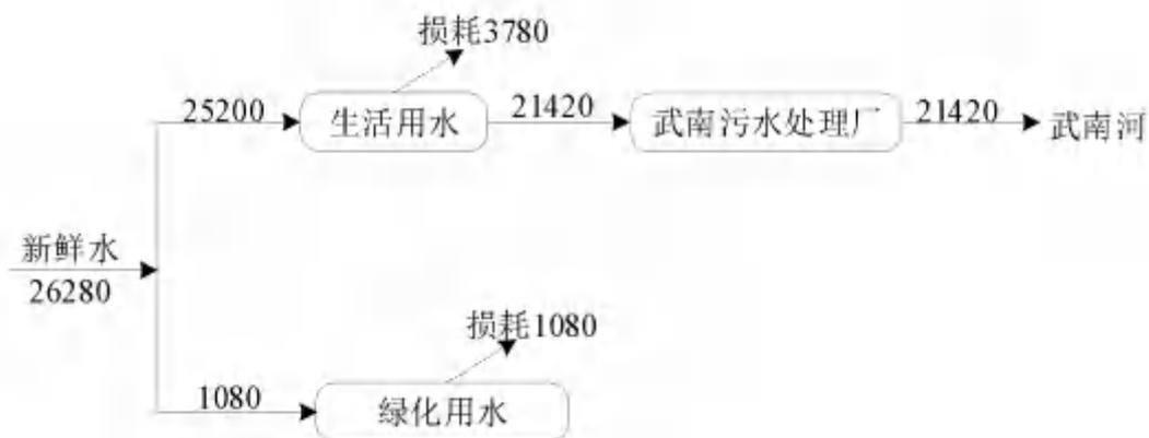
图 3-3 企业原项目水平衡图
